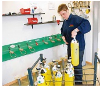
Durchgecheckt: Britta Jacobs prüft die Druckluftflaschen.
