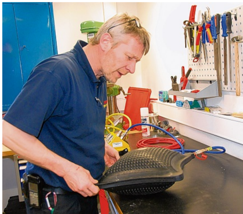
Aufpumpen bis kurz vorm Platzen: Auch dieses Hebekissen wird von Hans-Jürgen Schnoor genau unter die Lupe genommen.
